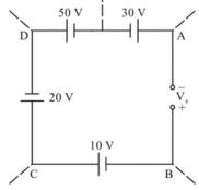
(a) -30 V(b) 20 V (c) 30 V\* (d) -20 V (SSC JE 2020) Hint: By KVL  $-V_{\text{S}} - 10 + 20 + 50 - 30 = 0$
